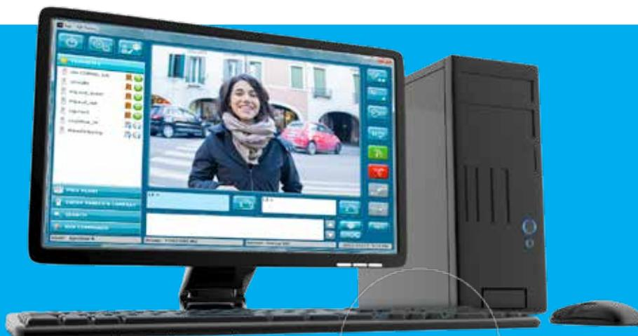
Este software, compatível com todos os PC com sistema operativo Windows, permite a supervisão total da instalação, nomeadamente para complexos habitacionais de grandes dimensões. No ecrã principal são apresentados os dispositivos da instalação com o respetivo ícone colorido que identifica o seu estado (livre, ocupado, etc.).
